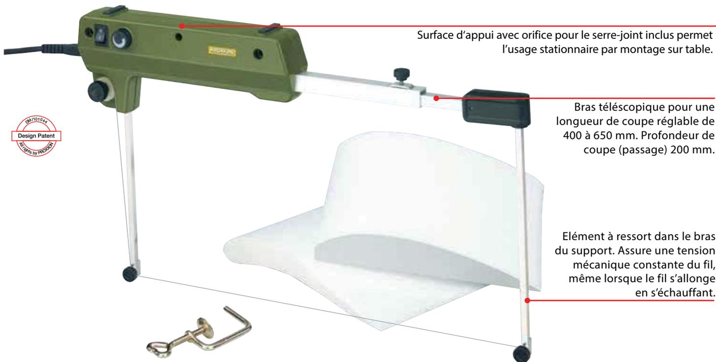
Avec alimentation en 230 V. L'élément chauffant fonctionne avec une tension de sécurité de max. 40 V et 1,2 A. La température de coupe peut être présélectionnée à l'aide d'un bouton rotatif et maintenue constante électroniquement pendant le travail avec l'appareil. Une surface d'appui avec orifice pour la fixation par serre-joint permet l'usage stationnaire. En plus du serre-joint, la livraison comprend une bobine de 30 m de fil de coupe Ø 0,2 mm.
