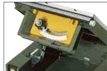
La table et l'entraînement peuvent être basculés vers le haut et verrouillés comme un capot moteur. Pour le nettoyage de l'appareil et le changement sans problèmes des lames de scie.
