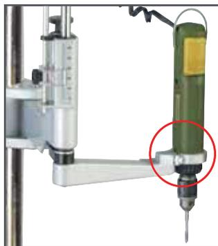
Grâce à l'interrupteur inverseur pour le sens de rotation à un régime de 250/mn, le MIS 1 convient remarquablement au taraudage: Le taraud est précisément guidé et permet des taraudages tout verticaux.
