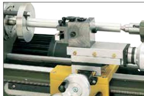
**Dispositif de tournage entre-pointes pour PD 400**
