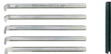
Pour filetages métriques 60° et Whitworth 55°. 1 pièce de 1,3 – 2,65 et 4 mm. Axe Ø 6 mm. Longueur totale 95 mm. Les burins sont à placer dans le porte-outil fourni (9 x 9 mm) et à serrer dans le porte-outil du PD 230/E, PD 250/E ou PD 400. Dans une boîte en bois avec couvercle coulissant.
