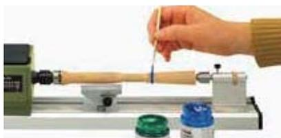
modélisme classique. Le réglage électronique du régime permet même à bas régime une «mise en peinture semi-automatique».
