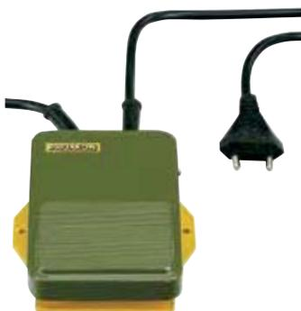
Pour tous les appareils à fiche européenne (classe 2) et d'une puissance jusqu'à 500 W max. Convient aussi aux appareils d'établi. Boîtier en NYLON renforcé de fibre de verre. Cordon 250 cm pour secteur 230 V. 50 cm de câble en sortie. Pour les appareils 12 V, l'interrupteur peut être branché au transfo.
