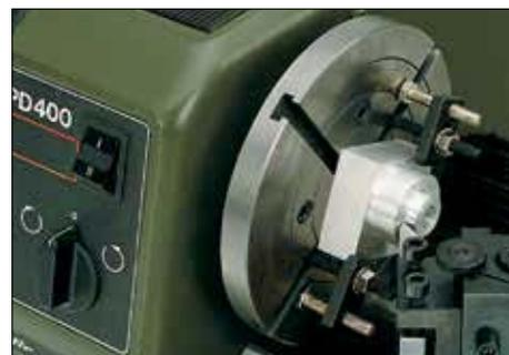
**Plateau de tournage avec brides de fixation** Se monte à la place du mandrin. Idéal pour le serrage de pièces de grande taille asymétriques. Ø 125 mm. Traversé par 2 rainures continues en T. Brides de serrage comprises. N° 24 412
