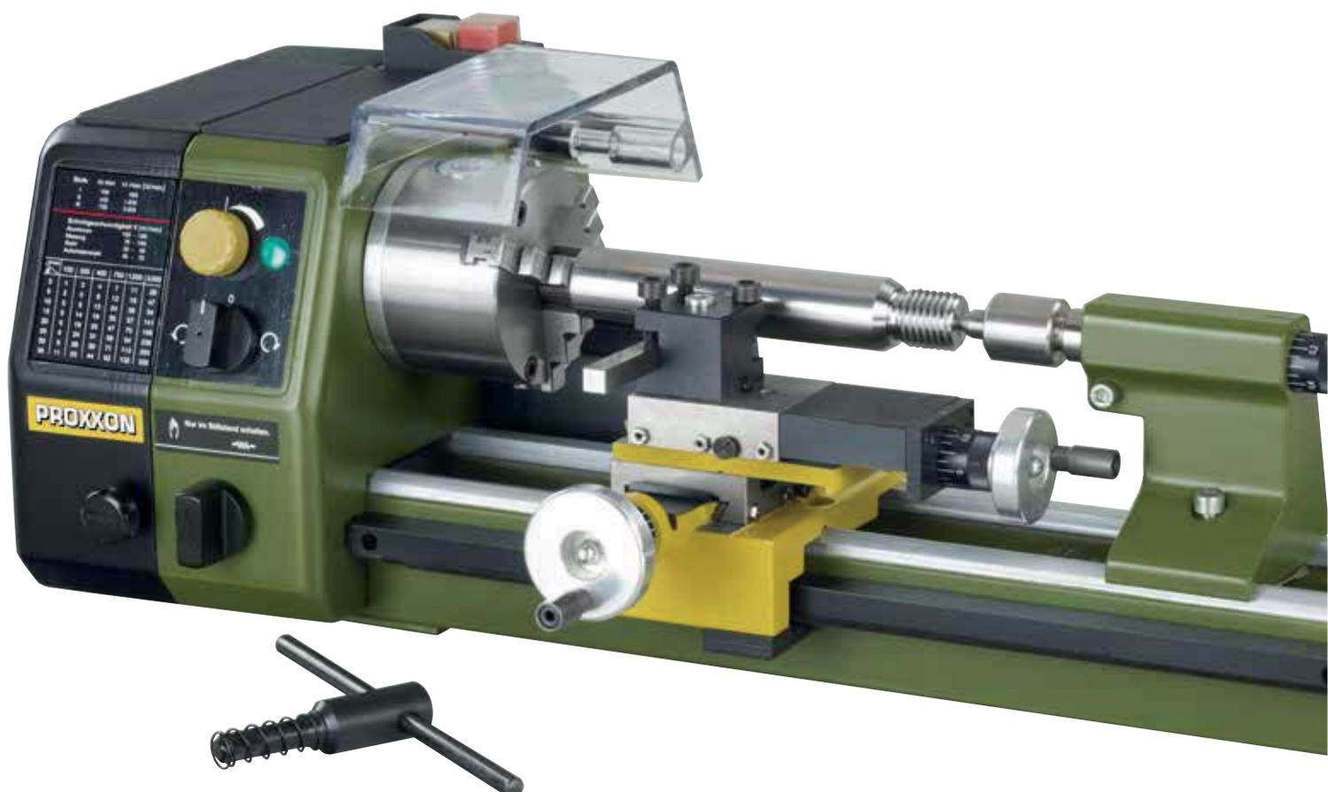
**Entre-pointes 250 mm. Hauteur des pointes 70 mm. Hauteur au dessus du support 43 mm.**
