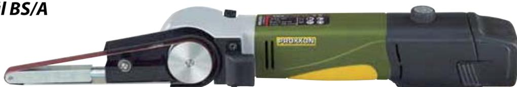
**Pour le ponçage de petites ouvertures, le finissage de formes et de surfaces, le polissage de rainures, le limage d'ébarbures et l'aplatissage de petites surfaces.** Basculement du bras de ponçage jusqu'à 60° par simple pression d'un bouton. Raccord d'aspiration avec adaptateur pour aspirateur permettant un travail propre. Avec 4 bandes de ponçage (2 à Gr 80 et 2 à Gr 180). La livraison comprend la batterie Li-Ion Li/A2 (10,8 V) et le chargeur de batterie rapide LG/A.
